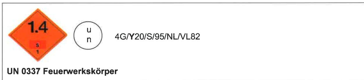
Gefahrzettelmuster und Kennzeichnung der Bauartzulassung (Symbol der Vereinten Nationen für Verpackungen, Verpackungstyp: Kiste aus Pappe, Verpackungsgruppe II, maximale Bruttomasse 20 kg, für feste Stoffe, 1995 hergestellt, in den Niederlanden zugelassen, Herstellerzeichen mit Zulassungsnummer), UN-Nummer und offizielle Benennung.
